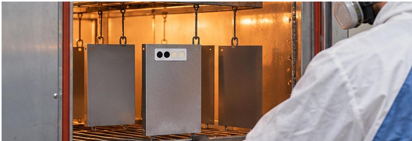
Címke a kijelölt próbadarabon. A címke a maximális elért szintet jelzi, a hőntartási időt nem.
